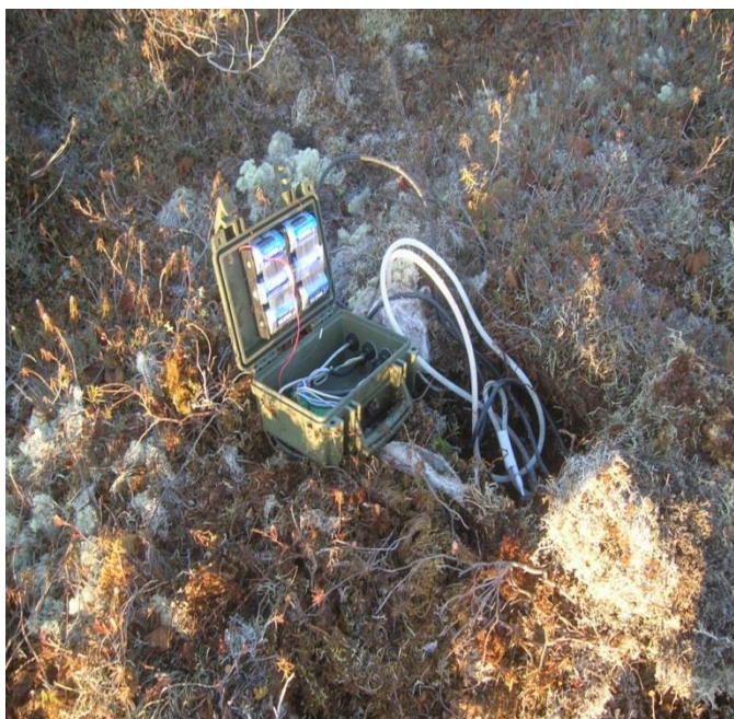
Рис.11. Блок управления автономной Системы автоматического мониторинга «САМ» после 2-х лет работы
