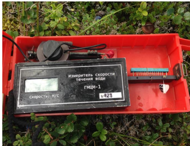
Рис. 8. Гидрометрическая микровертушка ГМЦМ-1
