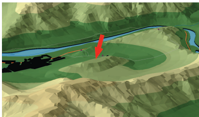
Рис. 28. Фрагмент трёхмерной модели рельефа окрестностей д. Малая Сяя в Июсском природном парке (Хакасия). Модель рассчитана без учёта дополнительных точек высот на вершинах гор. В результате гора Пилотка выглядит «скошенной» (красная стрелка)
